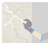
Untuk permukaan atau lapisan dinding interior yang terkena rembesan dan kelembapan air, Sumber yang menyebabkan rembesan dan kelembapan di dinding harus dihentikan, dinding harus dikeringkan secara menyeluruh dan kemudian proses pengecatan harus dimulai.
